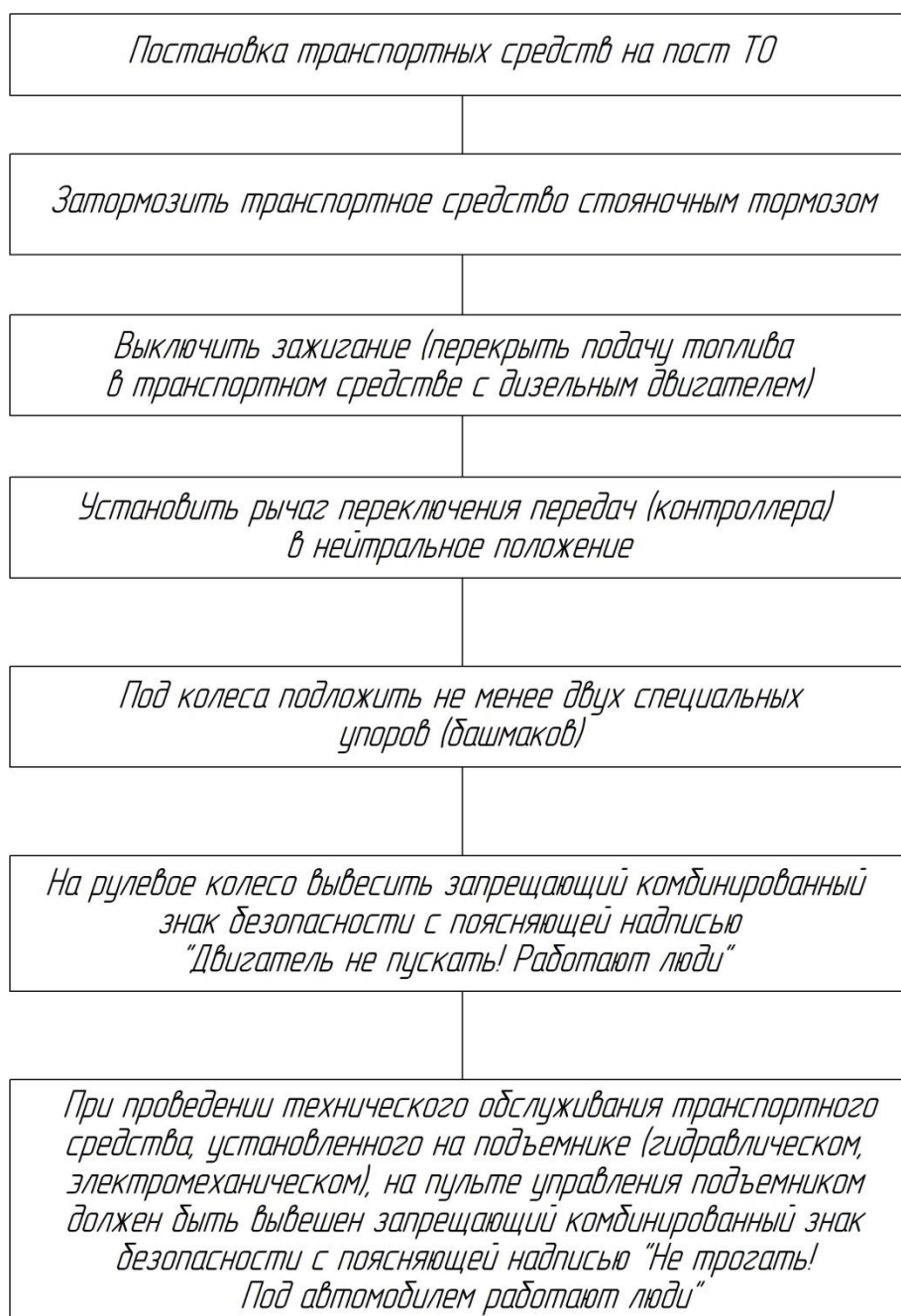
Рисунок 4 – Блок-схема анализа безопасности технологического процесса техобслуживания и ремонта автотранспорта
