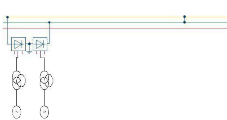
Рисунок 1 – Схема плавки гололёда для первого цикла с ПС Жигулевская-110 кВ
