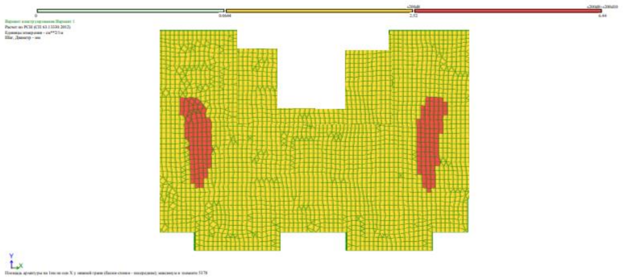
Рисунок 2.8 – Нижнее армирование ОХ
