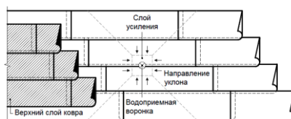
Рисунок 17 – Раскладка материалов у водоприемной воронки
