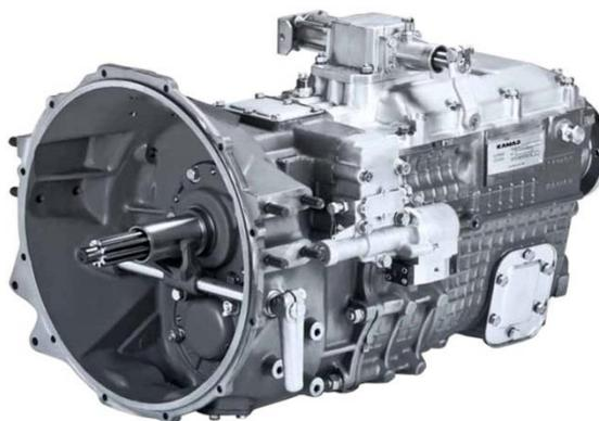
Рисунок 11- Общий вид коробки передач с делителем
