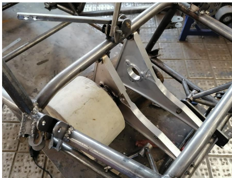
Рисунок 16– Плиты в сборе, с макетом электродвигателя
