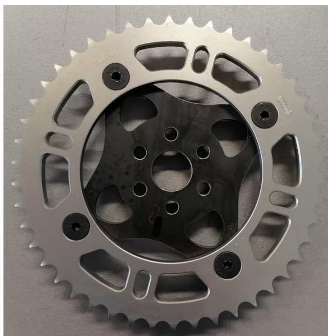
Рисунок 19–Ведомая звезда с проставкой на ШРУС электроболида 2021 года на 45 зубьев
