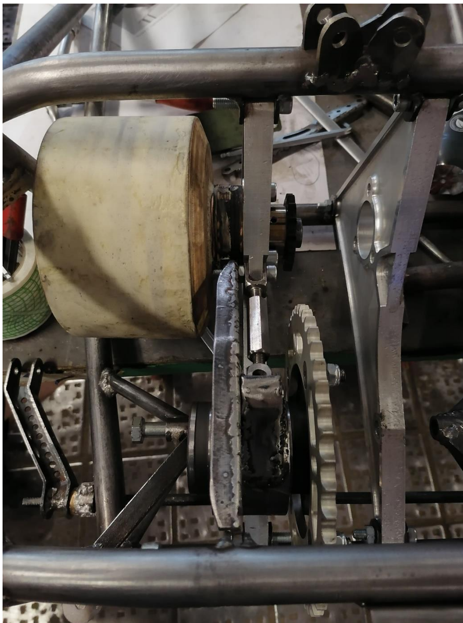
Рисунок 23 – Тяговый узел в сборе, с макетом электродвигателя
