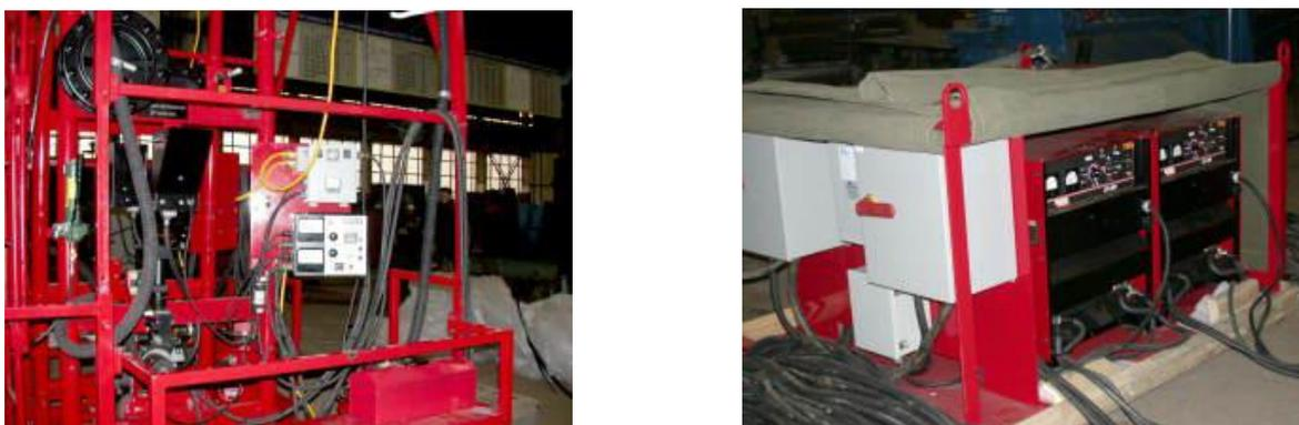
Рисунок 11 – Комплектация сварочной установки AGW-I: головка NA-3 (а) и выпрямители DC-600 (б)
