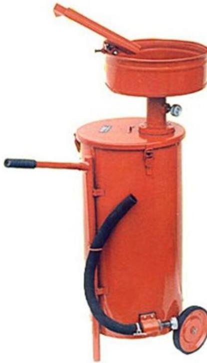
Рисунок 4 – Внешний вид маслосливной установки С-508
