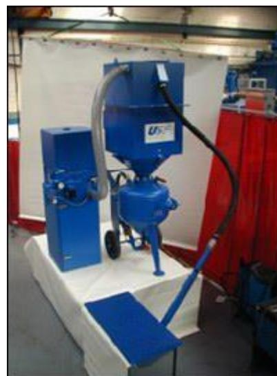
Рисунок 15 – Мобильные дробеструйные установки
