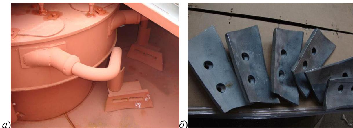
Рисунок 4 – Ротор (а) и лопатки (б) смесителя СБ-138А
