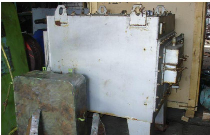
Рисунок 6 - Электрическая камерная печь СНО 3.6.2/10
