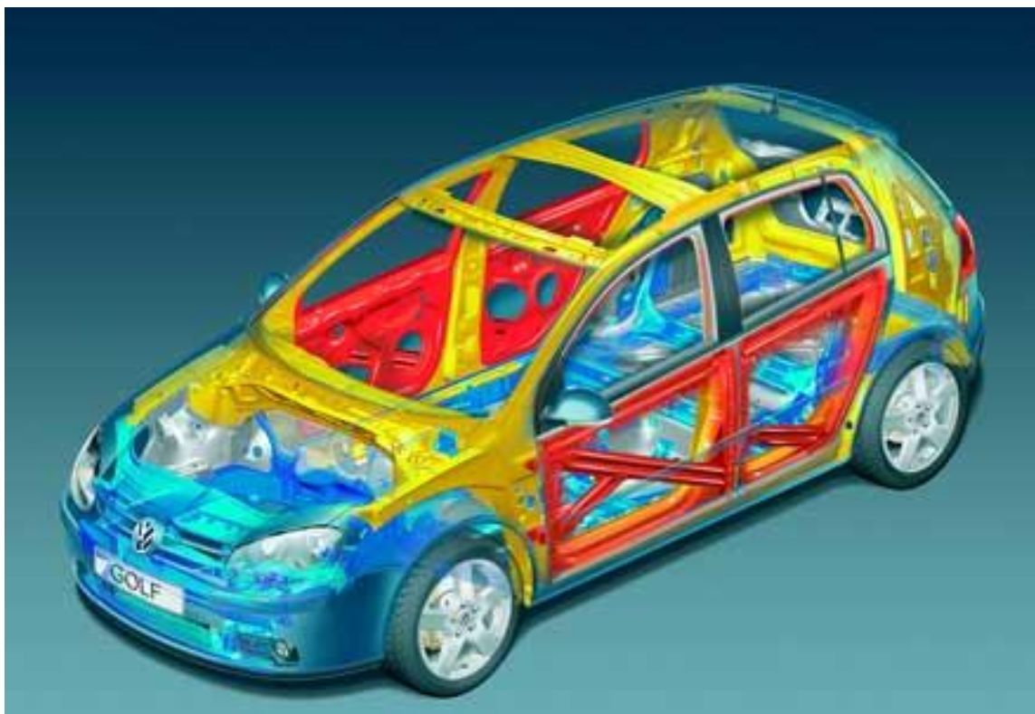
Рисунок 7 – Элементы программируемой деформации кузова
