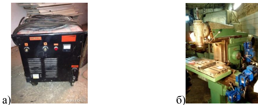
Рисунок 4 – Технологическое оборудование для восстановительной наплавки: а) сварочный выпрямитель ВД-301; б) универсальный фрезерный станок СФ676
