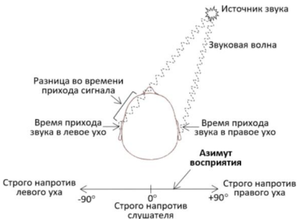
Рисунок 14 – Механизм локализации в горизонтальной плоскости по разности во времени
