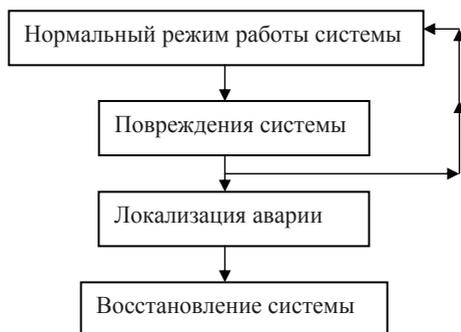
Рис. 27. Ход управления лавинным аварийным процессом
