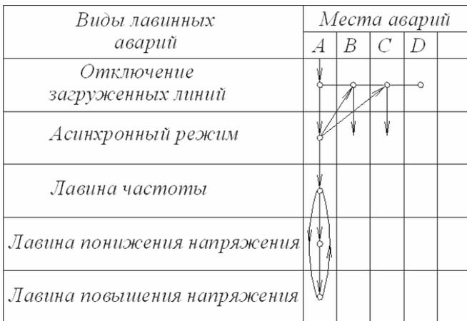
Рис. 33. Схема развития лавинных аварийных процессов
