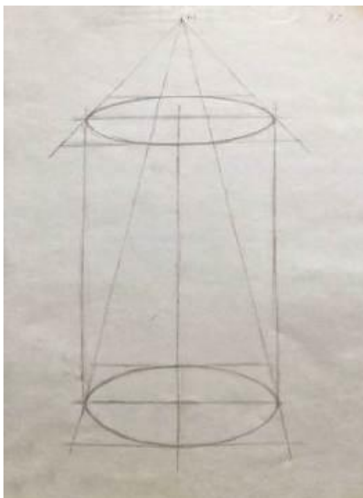
Рисунок Г.6 – Пятый этап построения цилиндра
