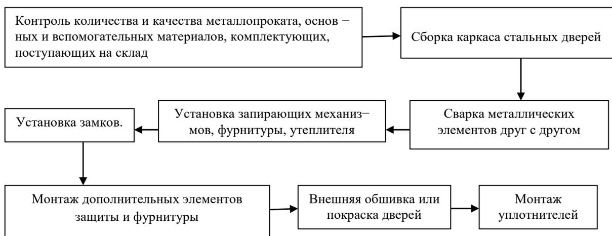
Рисунок 13 – Технология изготовления входных стальных дверей
