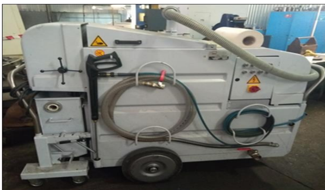
Рисунок 5 – Мобильная установка фильтрации СОЖ и очистки станков SF 500
