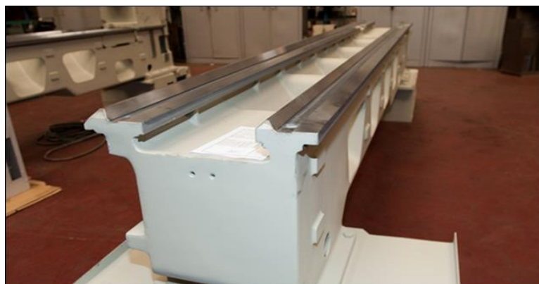
Рисунок 6 – Станина станка MASTURN 54CNC
