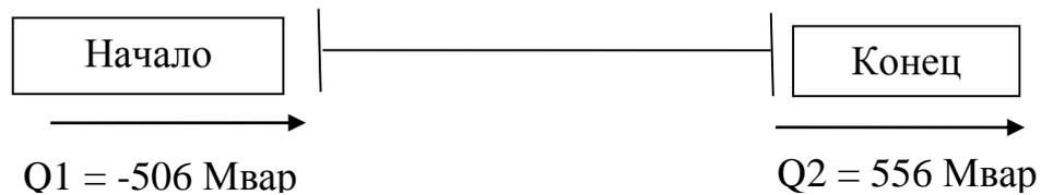
Рисунок 3 – Направление реактивных мощностей в минимальном режиме
