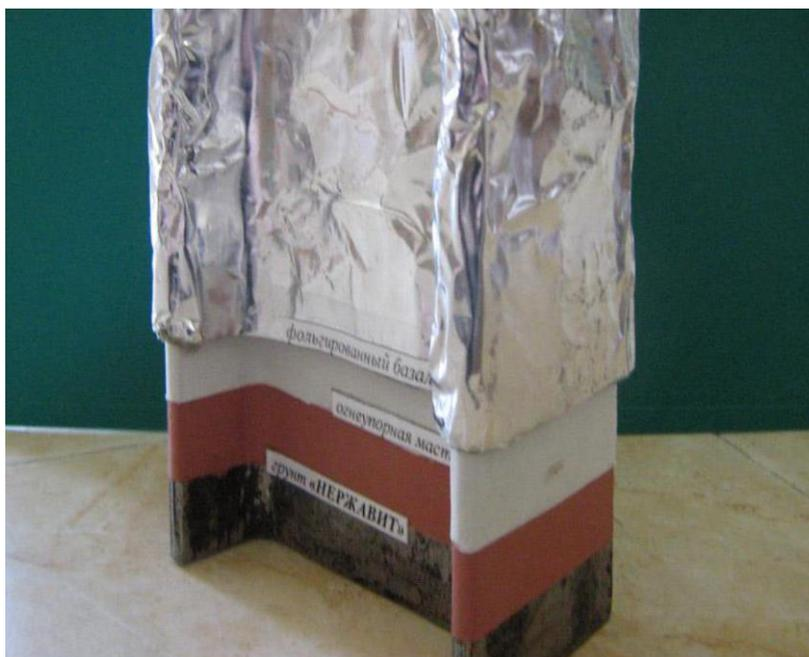
Рисунок 7 – Металлическая конструкция с нанесением конструктивного огнезащитного состава CompositTherm STEEL (CT-S).
