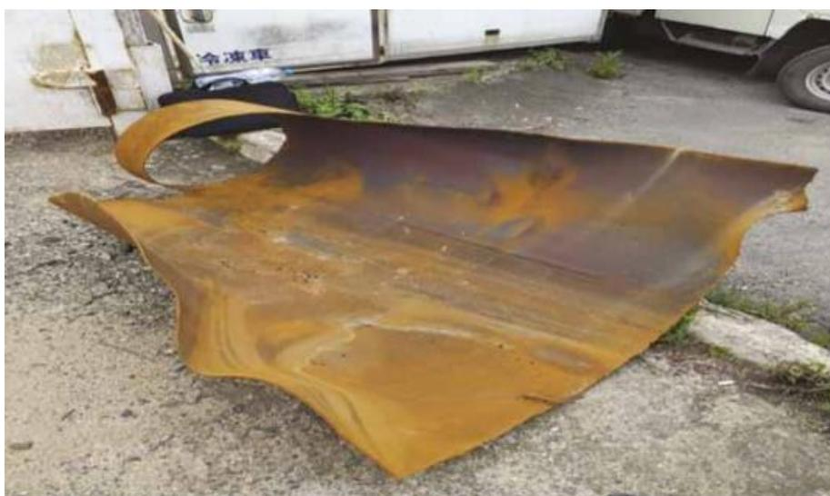
Рисунок 4 – Порыв паропровода СП «Приморские тепловые сети»
