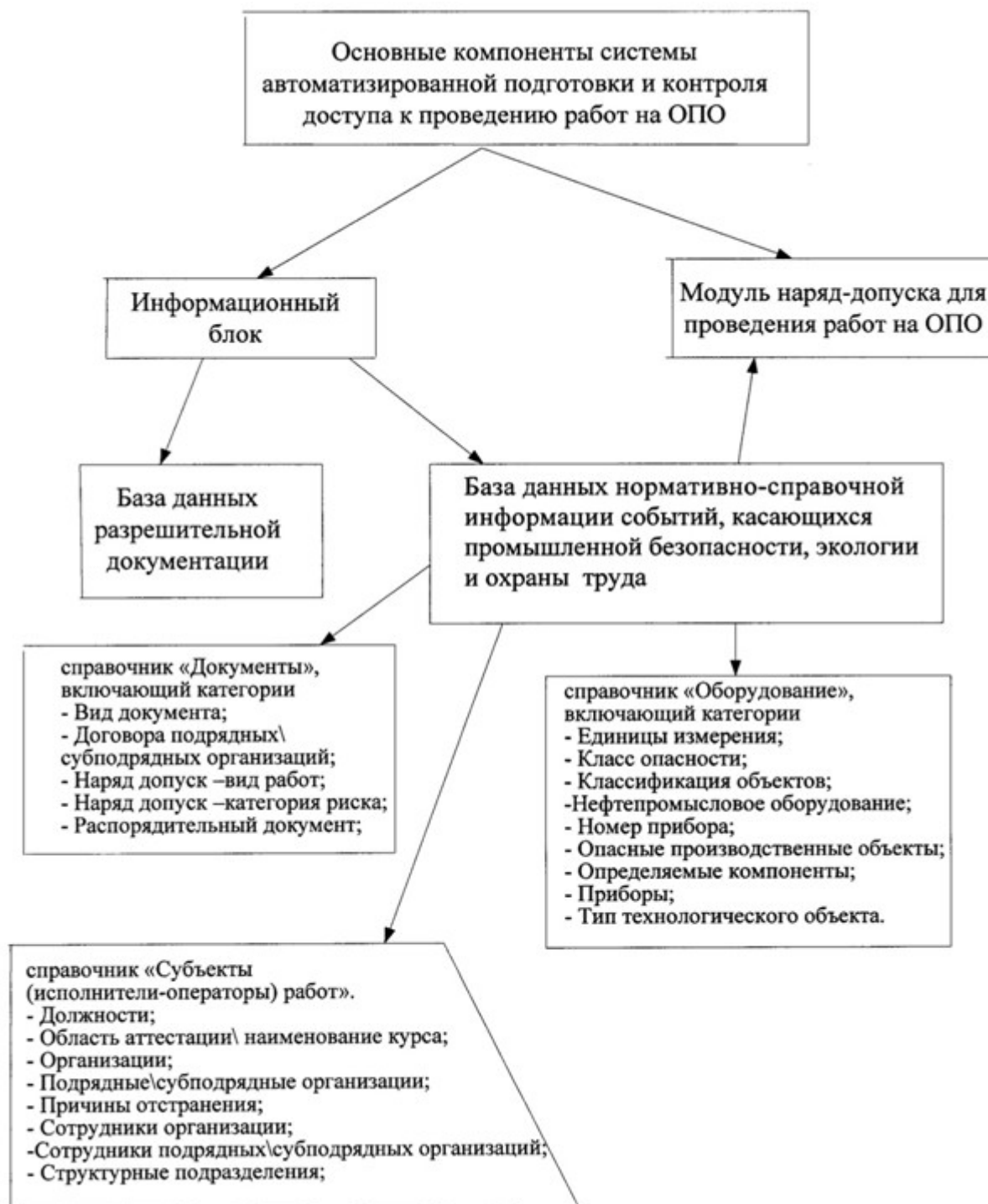
Рисунок 13 – Система автоматизированной подготовки и контроля доступа к проведению работ повышенной опасности на объектах нефтегазодобычи изобретения RU2672299C1
