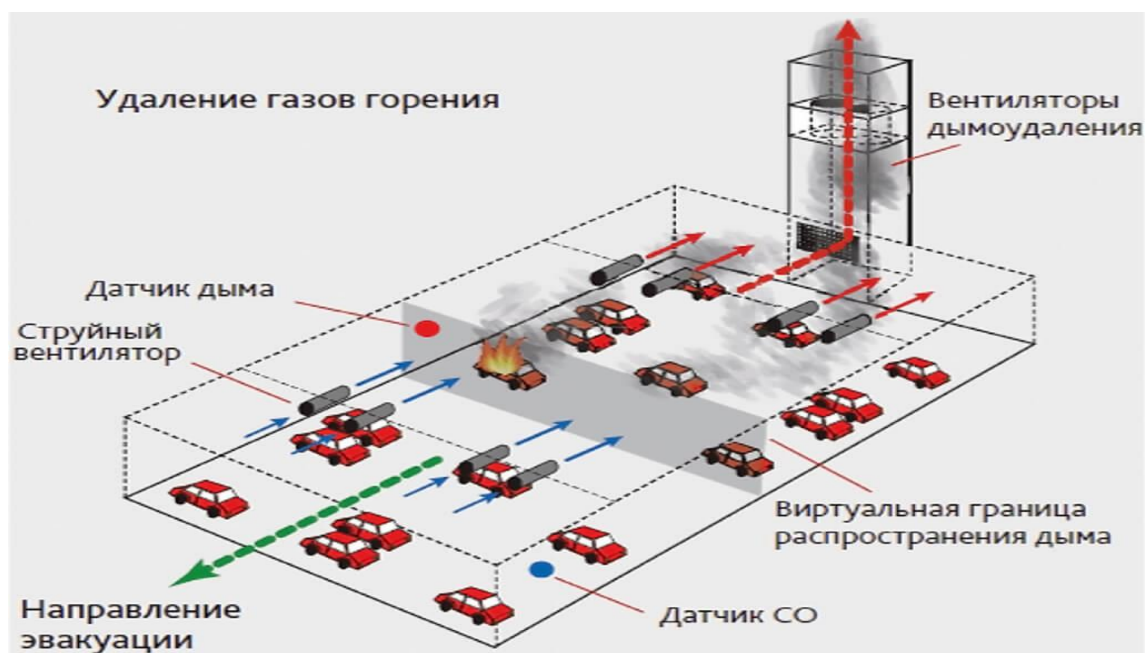
Рисунок 3 - Система пожарной безопасности паркинга
