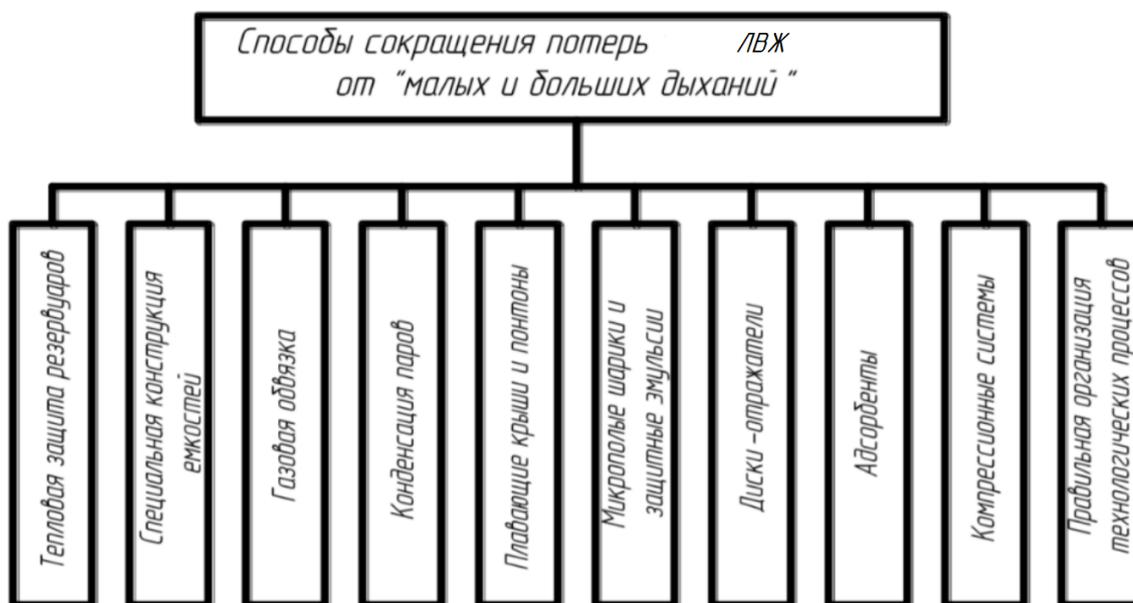
Рисунок 21 - Способы сокращения потерь паров ЛВЖ из резервуаров
