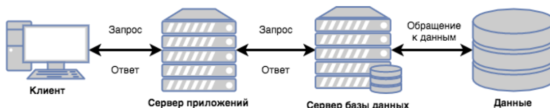
Рисунок 10 – Трехуровневая архитектура системы
