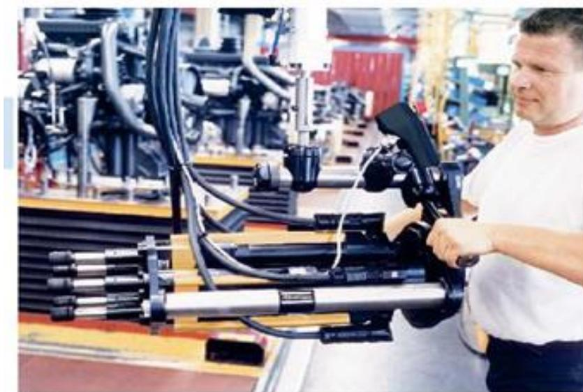
Рисунок 4.1 - Четырехшпindelный гайковерт модели MULTIPLES BY EXPRESS 3.1
