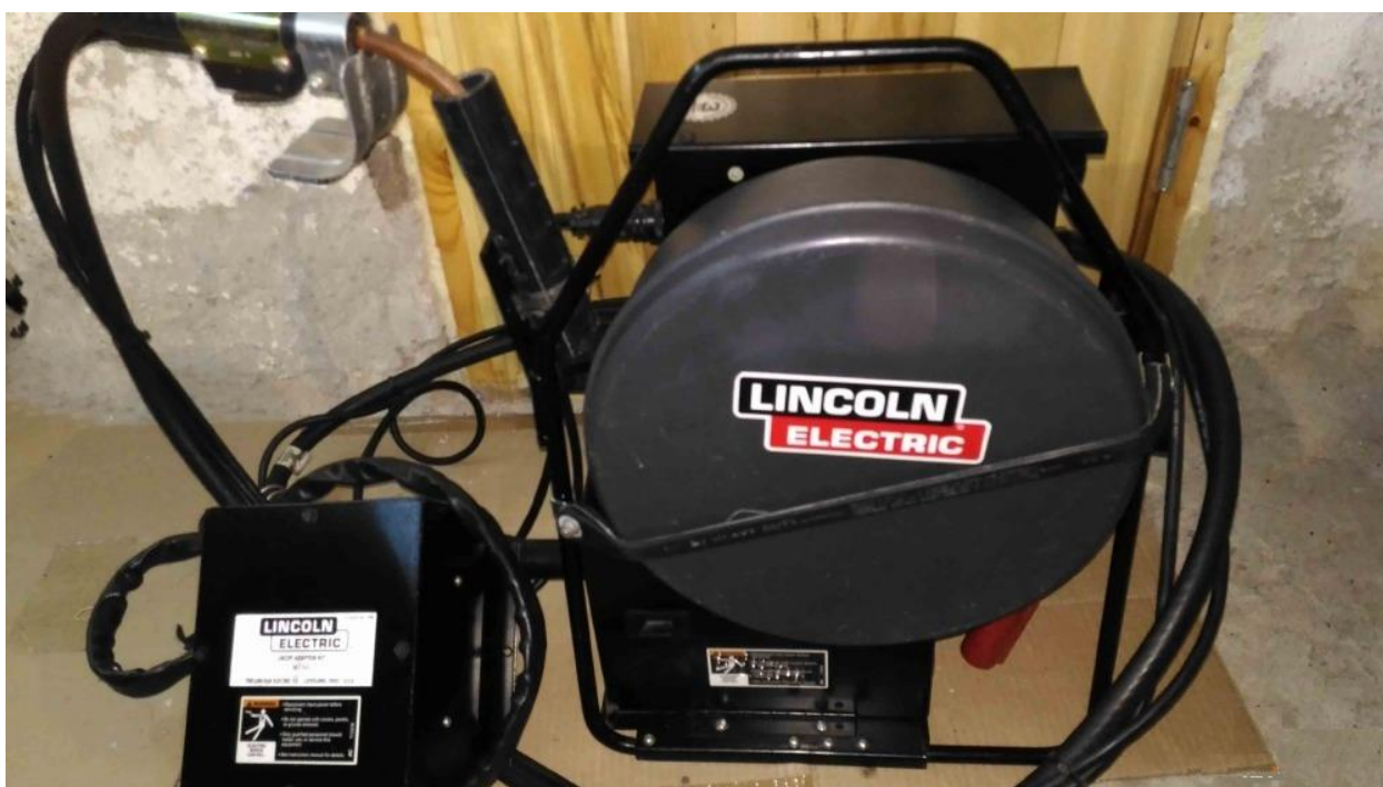
Рисунок 9 – Механизм подачи сварочной проволоки LN-23P
