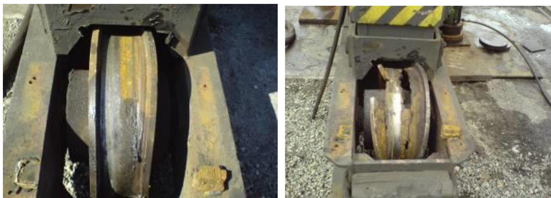
Рисунок 2 - Износ крановых колёс: отслоение поверхности катания и деформация реборды (а), разрушение колеса (б)
