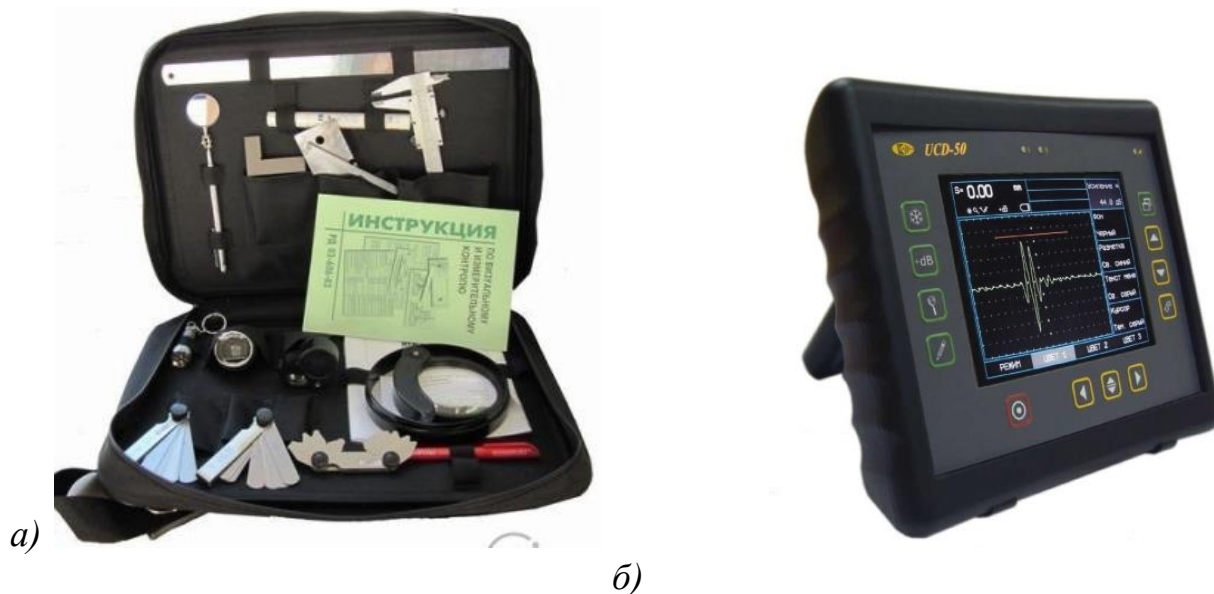
Рисунок 5 – Оборудование для проведения визуально-измерительного контроля (а) и ультразвукового контроля (б) сварных швов
