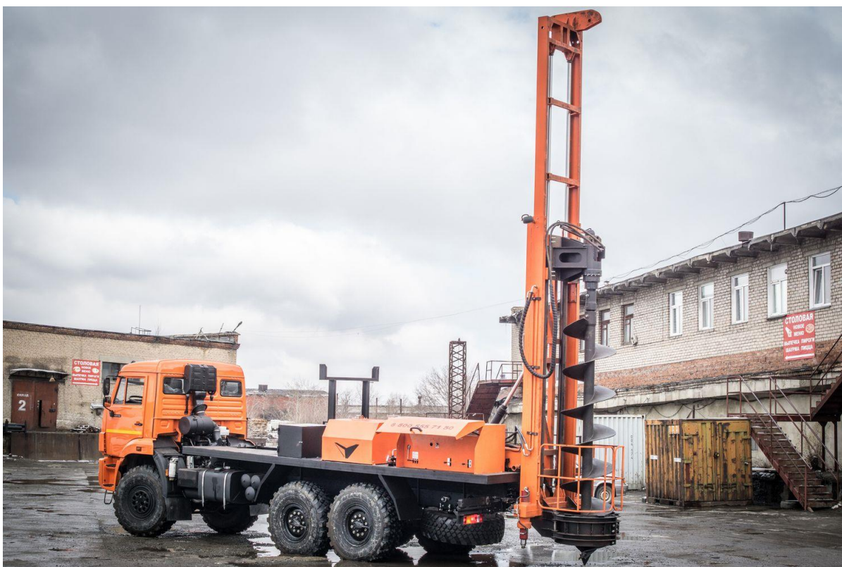
Рисунок 1 – Бурение скважины шнеком
