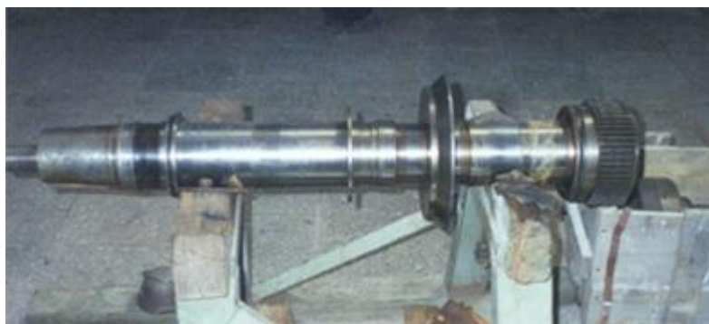
Рисунок 4 – Вал нагнетателя газа перед восстановлением посадочных поверхностей
