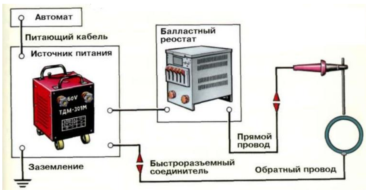
Рисунок 7 – Схема процесса ручной дуговой наплавки
