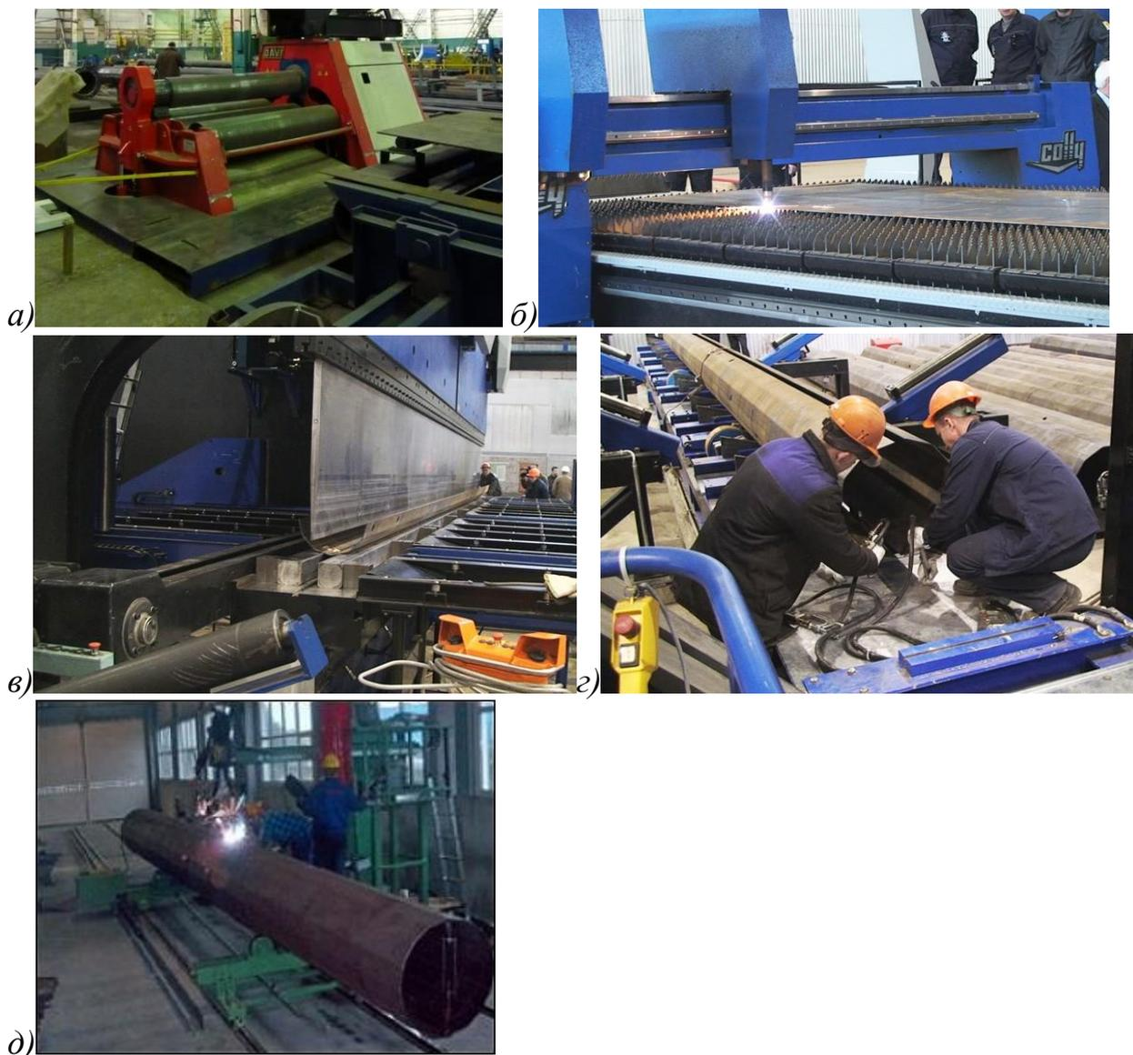
а) правка листовой заготовки; б) раскрой заготовки; в) гибка листовых заготовок;
