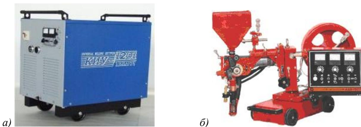
Рисунок 5 – Оборудование для сварки продольного шва секции опоры: выпрямитель ВДУ-1201 (а) и сварочный автомат АДФ-1202 (б)
