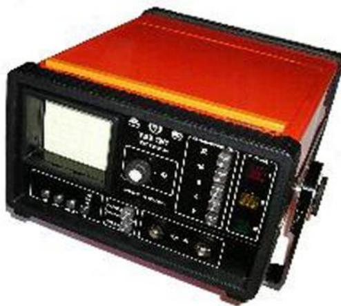
Рисунок 6 – Дефектоскоп УД2-12
