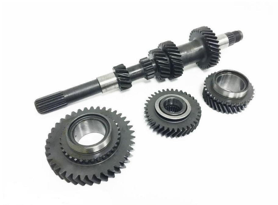
Рисунок 8 – Установочный комплект коробки передач
