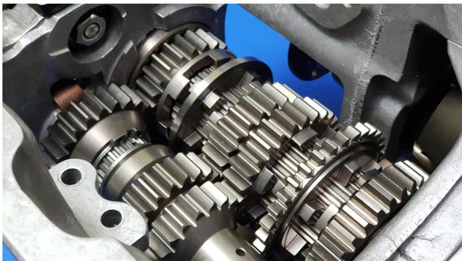
Рисунок 7 – Элементы кулачковой коробки передач фирмы Quaife.
