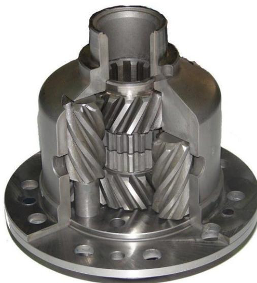
Рисунок 9 – Винтовой самоблокирующийся дифференциал
