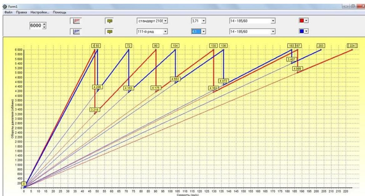
Рисунок 6 – Расчет скорости разгона автомобиля
