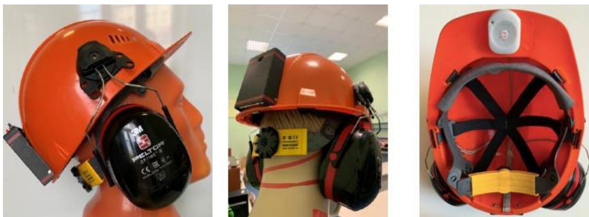
Рисунок 30 – Изготовленный прототип с функциями мониторинга и сигнализации
