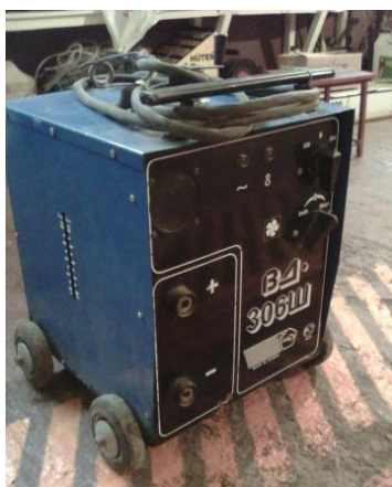
Рисунок 14 – Сварочный выпрямитель ВД-306Ш
