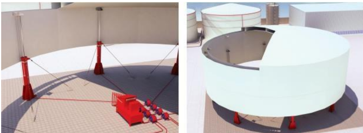
Рисунок 5 – Возведение резервуара методом подрачивания
