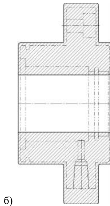
Рисунок 2 – Эскизы заготовок: а – прокат; б - штамповка
