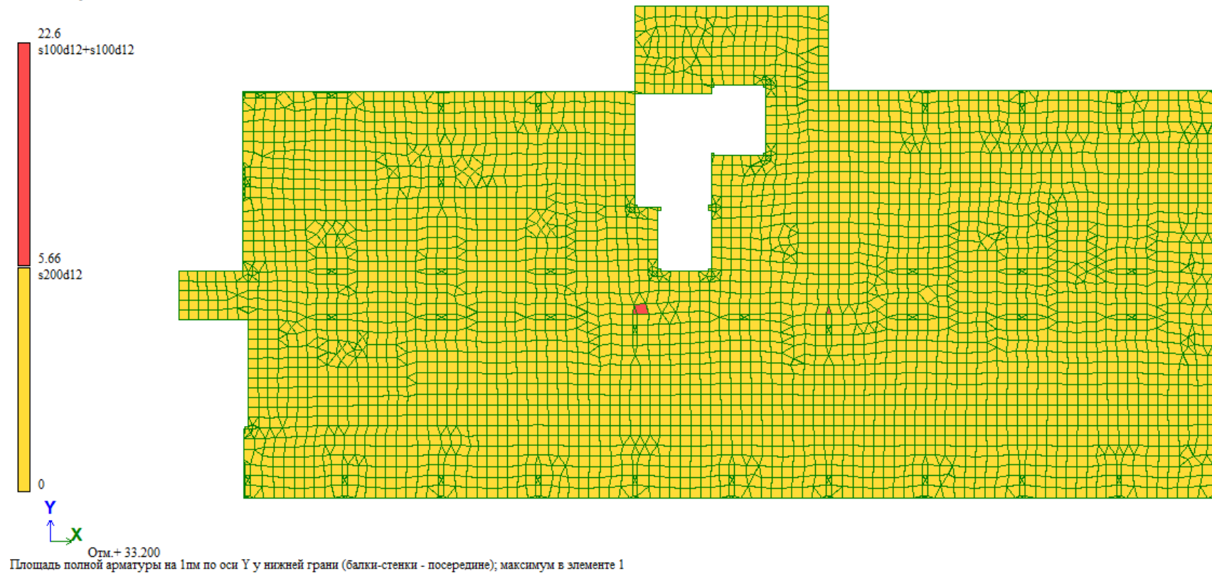
Рисунок Б.9 – Площадь арматуры на 1м по Y у нижней грани
