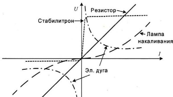
Рис. 5.2. Вольтамперные характеристики нелинейных элементов
