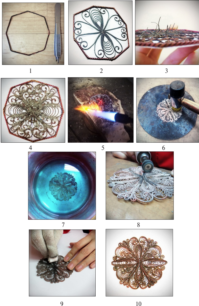
Рис. 29. Этапы процесса изготовления декоративных элементов в виде снежинки: 1 – пайка внешнего кольца; 2 – набор скани по рисунку; 3 – скрепление элементов; 4 – флюсование; 5 – пайка; 6 – исправление; 7 – отбеливание; 8 – полирование; 9 – оксидирование; 10 – готовый результат
