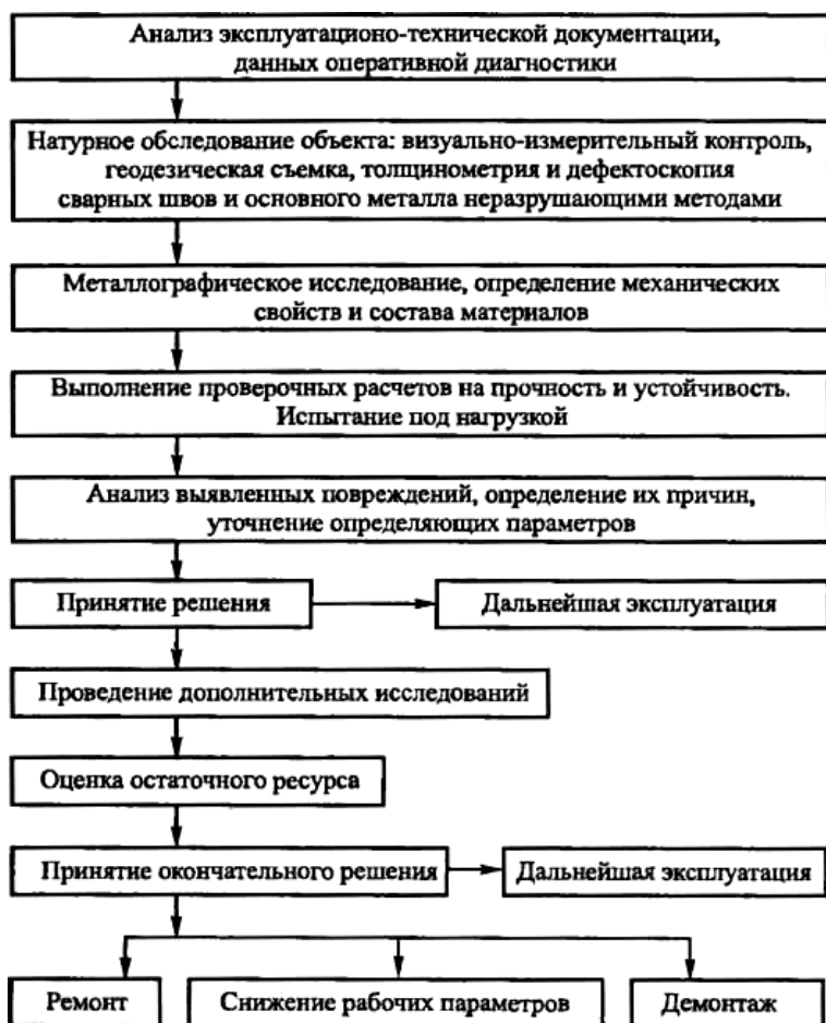
Рис. 1.2. Типовая схема технического диагностирования
