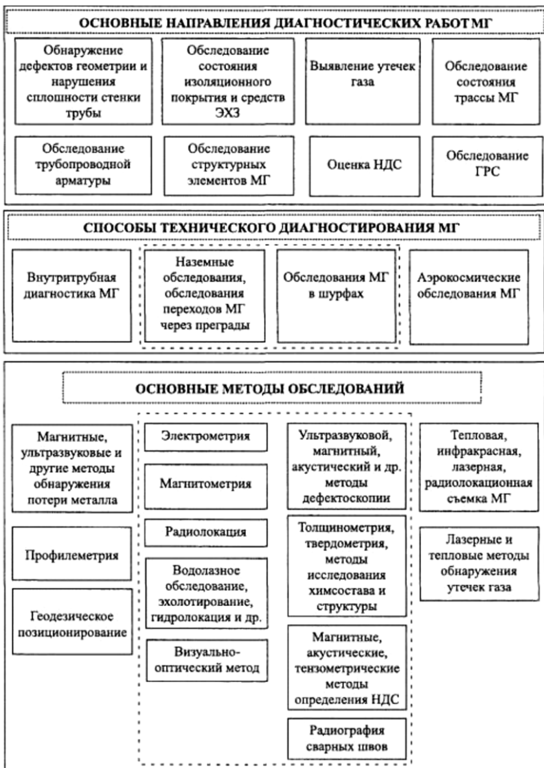
Рис. 2. Структурная схема комплекса диагностических работ на МГ
