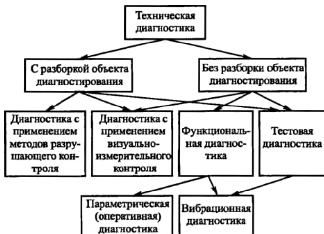
Рис. 1.1. Классификация видов технической диагностики
