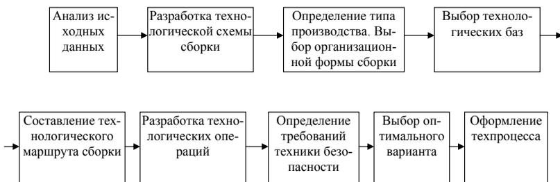
Рис. 1.4. Порядок проектирования технологических процессов сборки изделий
