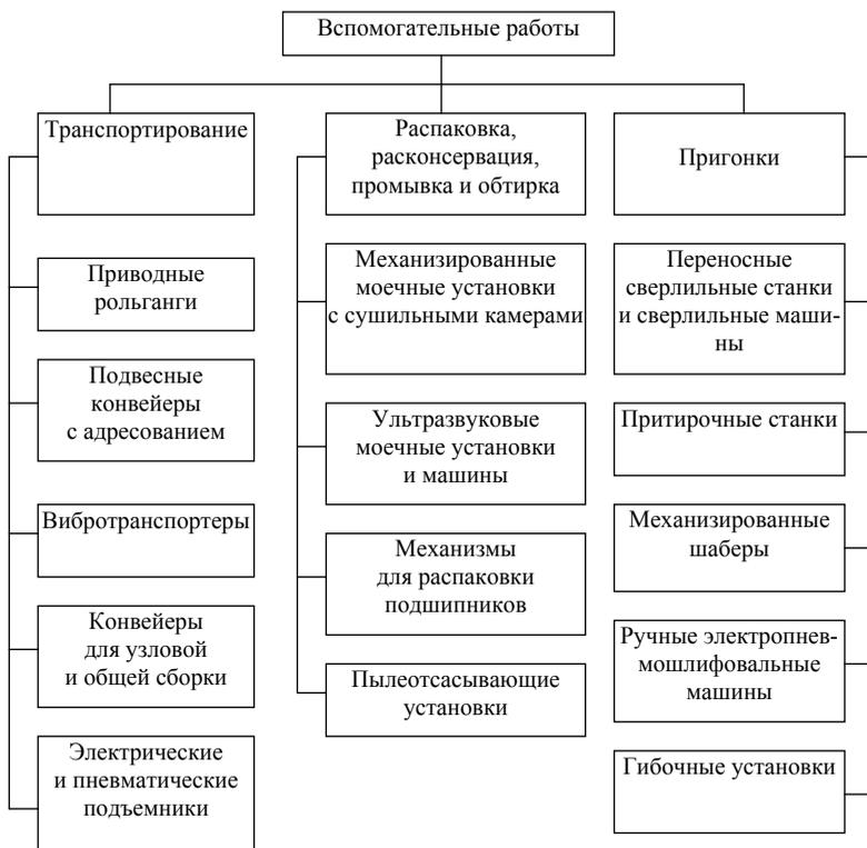
Рис. 1.8. Оборудование для вспомогательных сборочных работ
