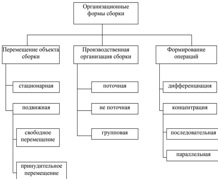
Рис. 1.6. Организационные формы сборочных технологических процессов
