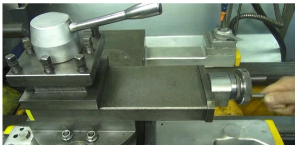
Рисунок 1.22 – Быстрое вращение рукояток за одну из ручек
