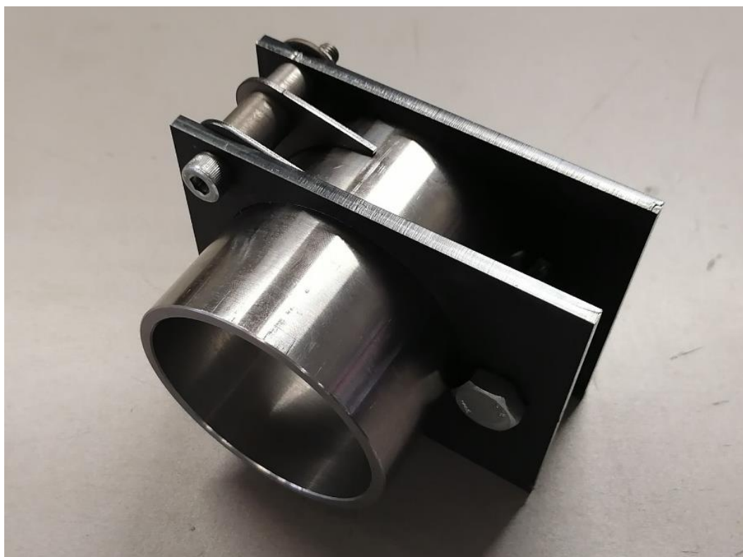
Рисунок 19 – оснастка для сборки и сварки корпуса ШРУСа [17]
