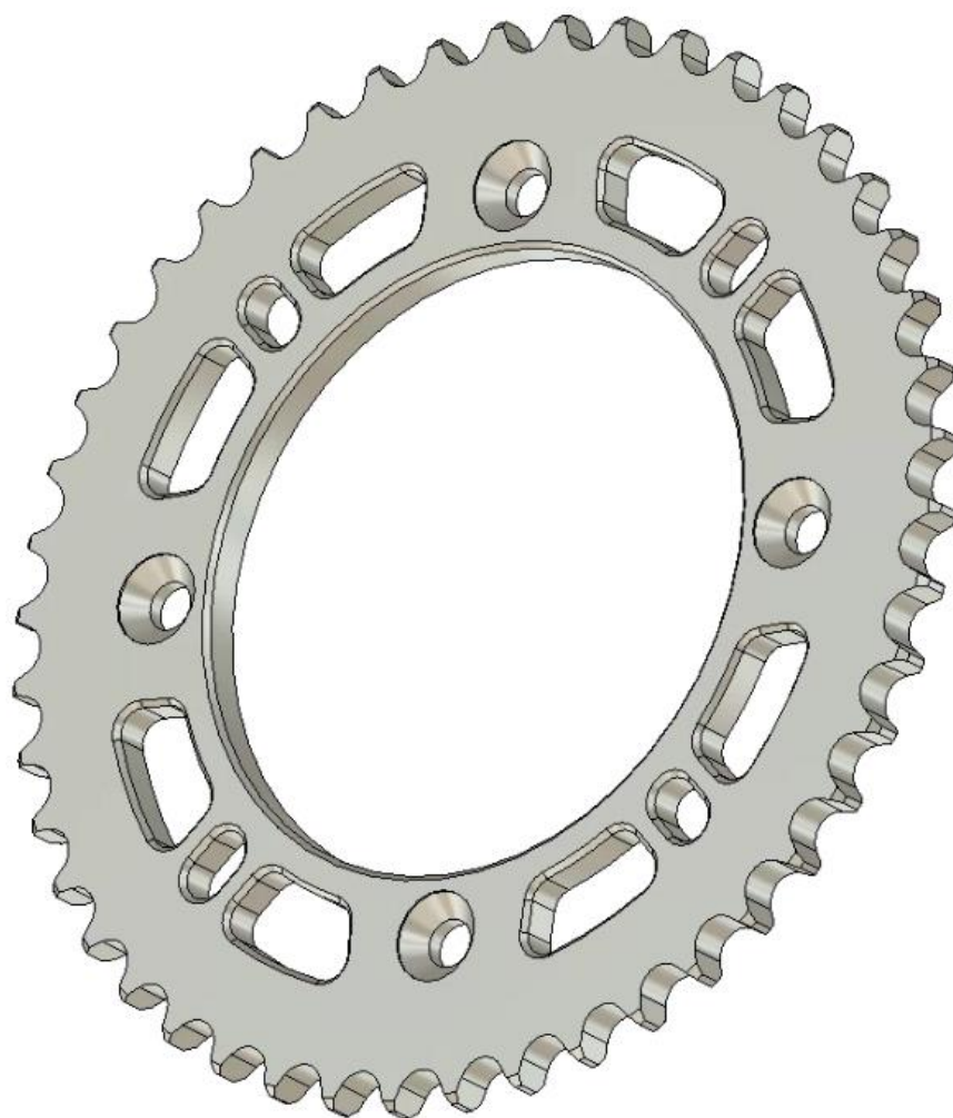
Рисунок 4 – Ведомая звезда задняя алюминиевая AFAM 72102-46
