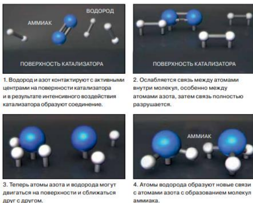
Рисунок 16 – Процесс формирования связей между атомами азота и водорода
