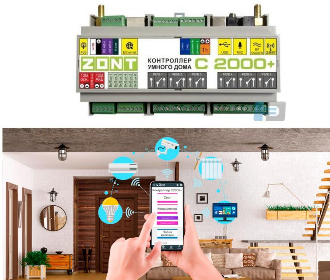
Рисунок 2 – контроллер ZONT C-2000+ и управление со смартфона
