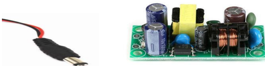
Рисунок 7 – Внешний вид платы блока питания с разъемом DC5.5-2.1
