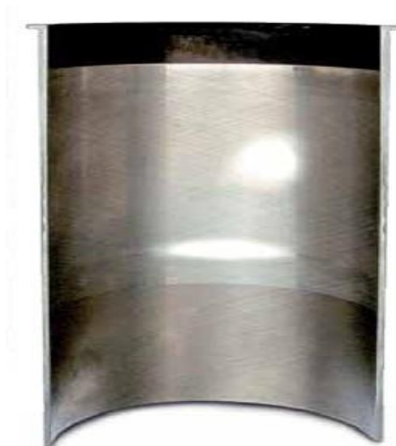
Рисунок 4 - Неравномерный износ рабочей поверхности
