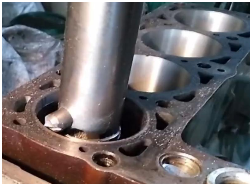
Рисунок 19 – Установка резца и процесс растачивания
