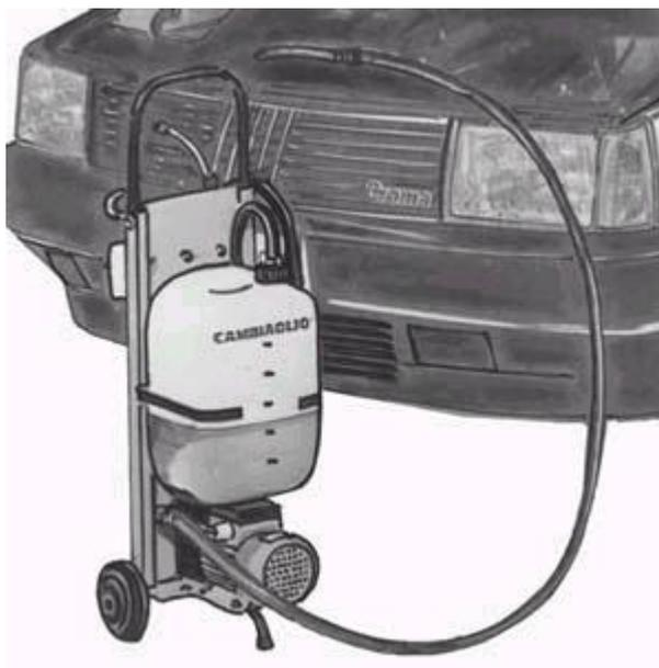
Рисунок 2.2 - Установка для слива отработанного масла GOVONI 305
