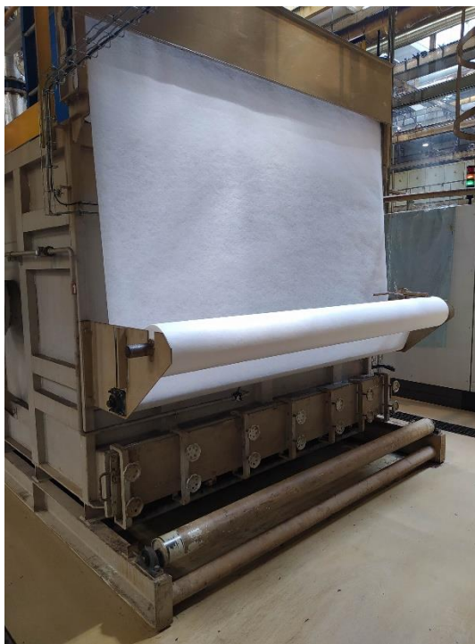
Рисунок 9 – Система подачи нетканого фильтровального полотна на установке подачи и очистки СОЖ
