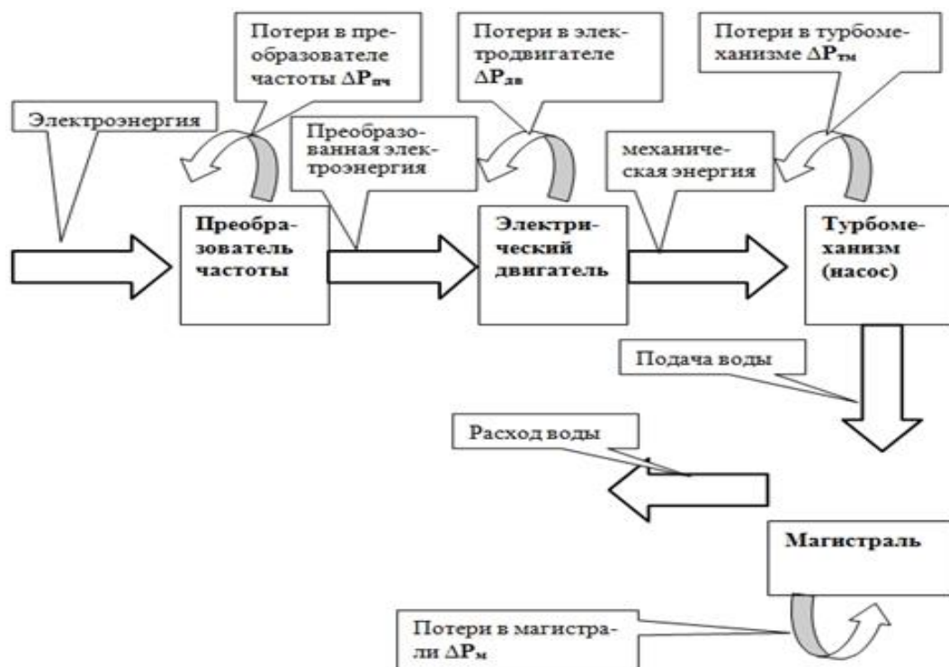
Рисунок 16 – Энергетическая диаграмма насосного агрегата
