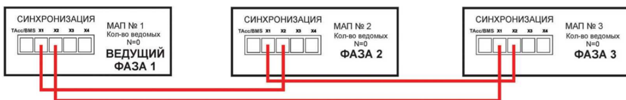
Рисунок 26 – Схема соединений МАП
