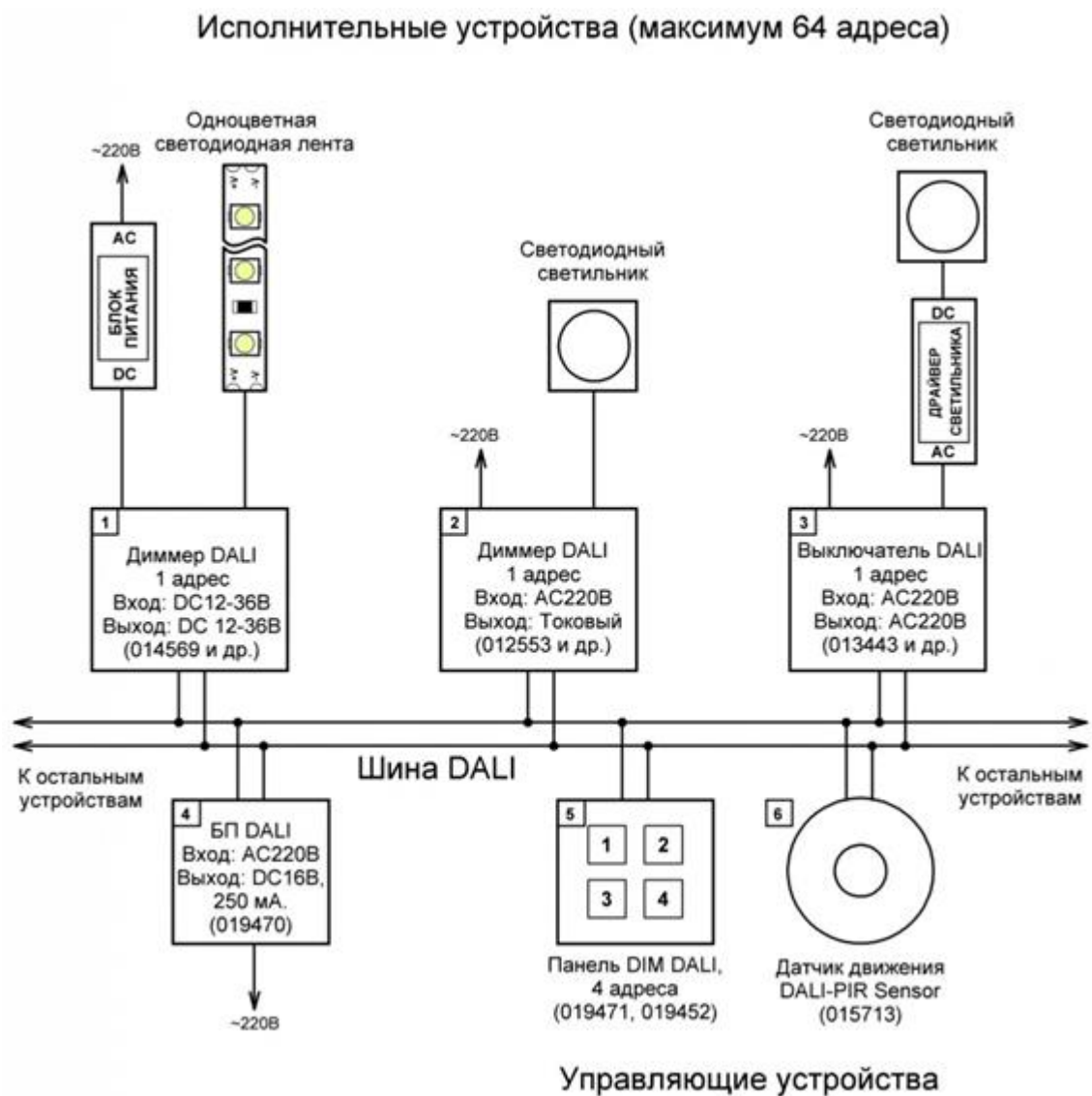
Рисунок 6 – Схема подключения устройств DALI
