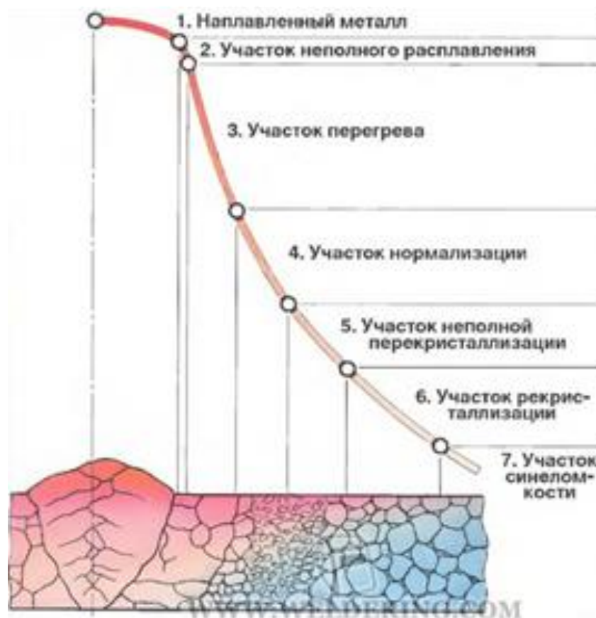
Рисунок 56 - Термический цикл сварки и структура сварного соединения.
