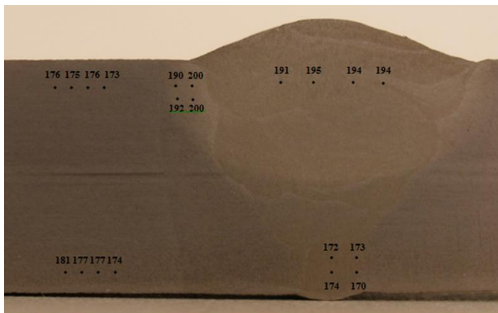
Рисунок 53 - Фото сварного шва с измерениями твердости заваренной проволокой \varnothing 1.6 мм
